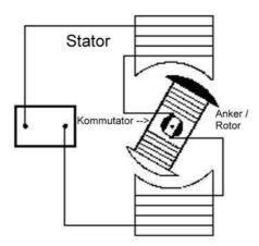
Der Stator erzeugt ein Permanentmagnetfeld, in dem der Rotor (bzw. Anker oder Läufer) rotiert. Dadurch, dass sich gleiche Magnetpole abstoßen und sich gegenseitige Pole anziehen, bewegt sich der Rotor. Sobald der Rotor am Neutralpunkt (jeweils nach einer halben Drehung) angekommen ist, wird durch den Polwender die Polarität des Rotors getauscht, wodurch die nächste halbe Drehung hervorgerufen wird.
